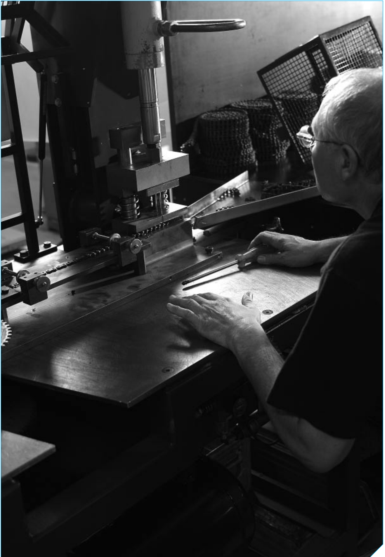
Couper une chaîne en petits morceaux afin de pouvoir monter des attaches (à Dordrecht)
